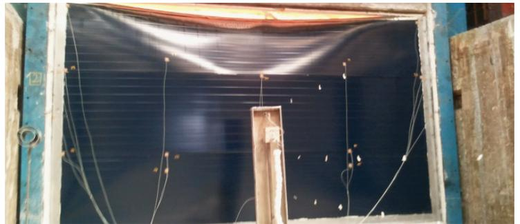
Cloison en panneaux sandwich de dimensions 5000 x 3000 mm (l x h)
