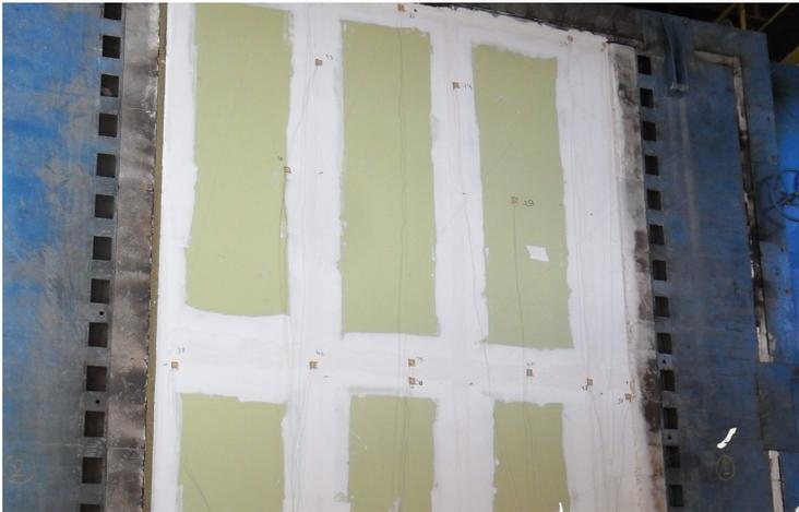
Cloison en plaques de plâtre de dimensions 3000 x 5000 mm (l x h)
